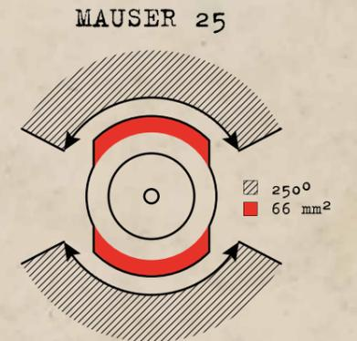
Der „MAUSER-Spread-Lock-250“ verriegelt mit zwei
