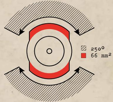
Der „MAUSER-Spread-Lock-250“ verriegelt mit zwei Stützklappen auf einer Fläche von 66 mm<sup>2</sup> in einem Winkel von zweimal 125 Grad.
